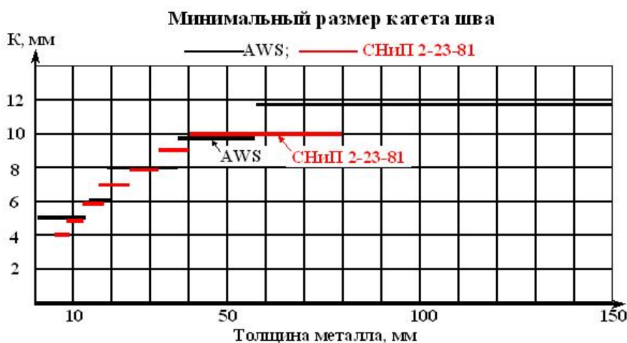
Рис.3.16. Рекомендуемое минимальное значение катета углового шва
